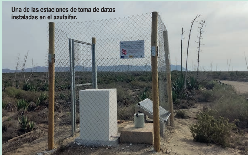
Estación para el seguimiento de gases de efecto invernadero en ecosistemas áridos.
