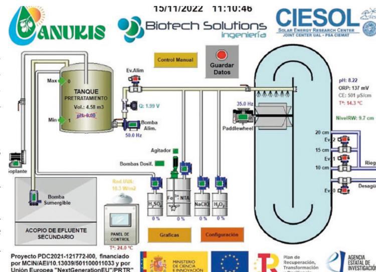
Diagrama del reactor instalado en la EDAR de Uleila del Campo para desarrollar el proyecto ANUKIS de regeneración de aguas mediante radiación solar.
